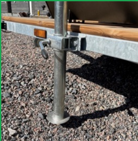
KUVA 2 (Tukijalat ennen täyttöä)
